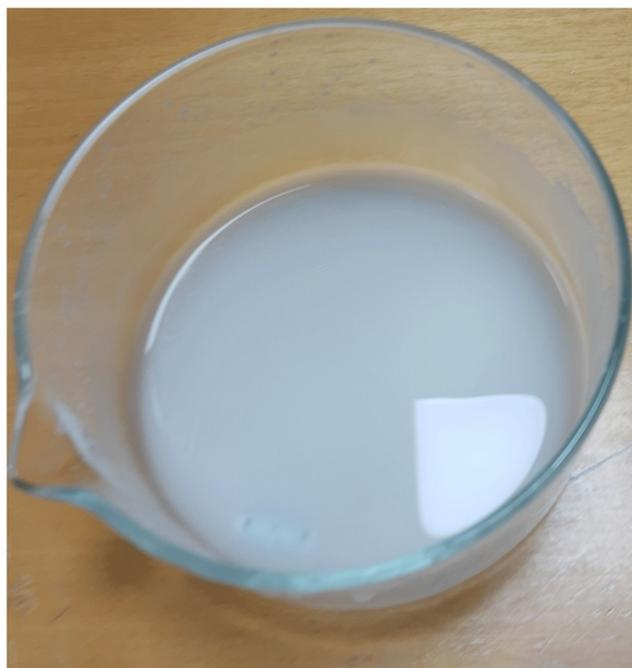
**Figura 5:** Mezcla resultante con la que se impregnará el papel para fabricar las tiras de medición.
