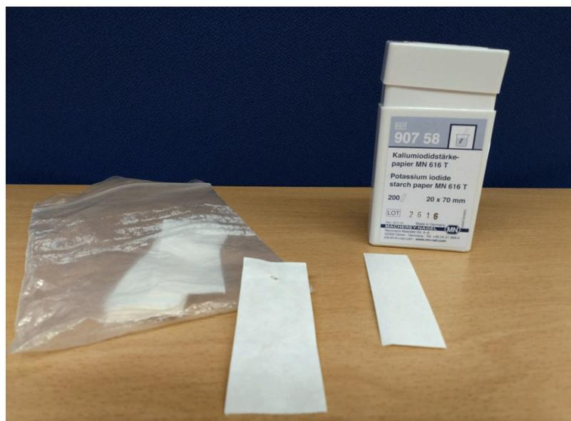
**Figura 7:** Comparación entre tira de papel de medición fabricada siguiendo el procedimiento aquí expuesto (izquierda) con una provista comercialmente (derecha).
