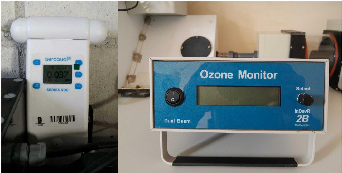
**Figura 9:** (izquierda) ozonómetro de medida por semiconductor sensible al gas; (derecha) ozonómetro de medida por absorción ultravioleta.
