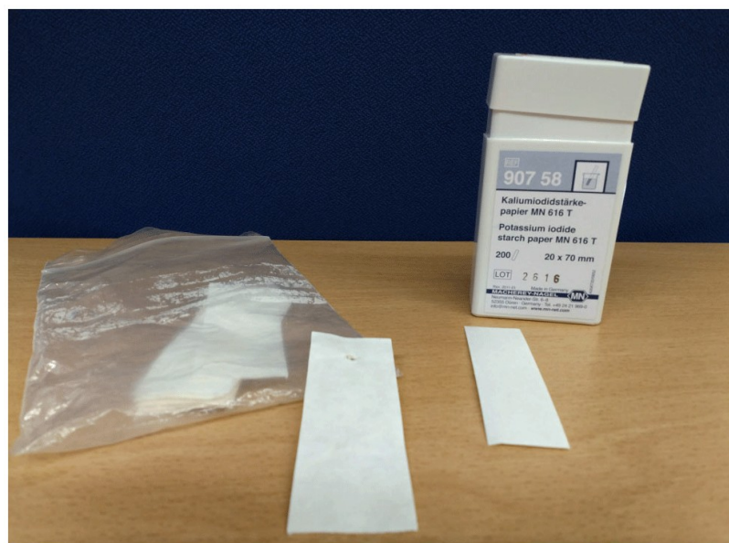
Figura 7. Comparación entre a tira de papel de medición fabricada seguindo o procedemento aquí exposto (esquerda) e una provista comercialmente (dereita)
