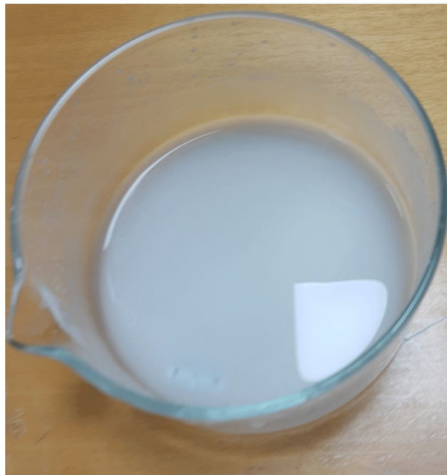
Figura 5. Mestura resultante ca que se impregnará o papel para fabricar as tiras de medición.
