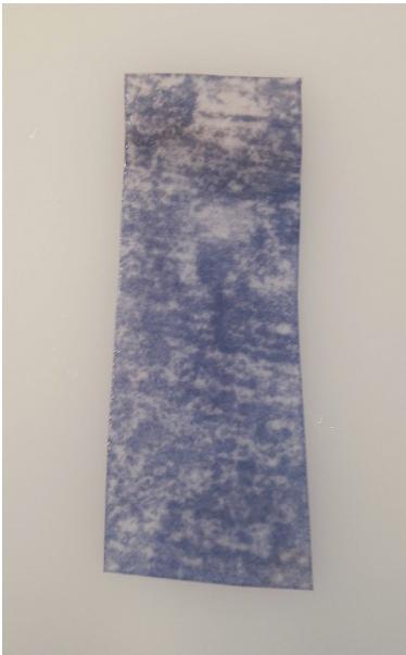
Figura 6. Tira resultante da que tomar a medición unha vez exposta durante 24 horas ao aire exterior e tras ser inmersa en auga destilada
