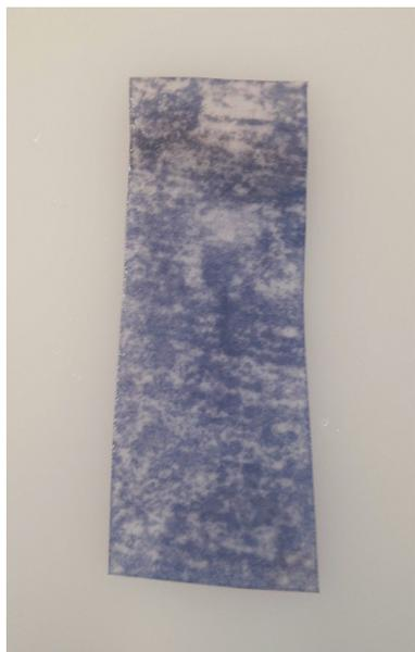
**Figura 6:** Tira coletada, com a qual se faz a medição, depois de exposta por 24 horas ao ar ambiente e imersa em água destilada.
