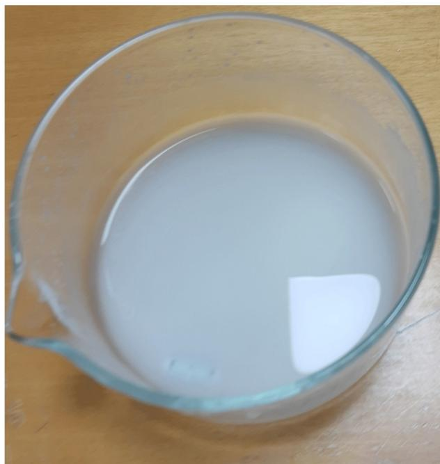
**Figura 5:** Mistura resultante da solução de KI e amido em água destilada quente.
