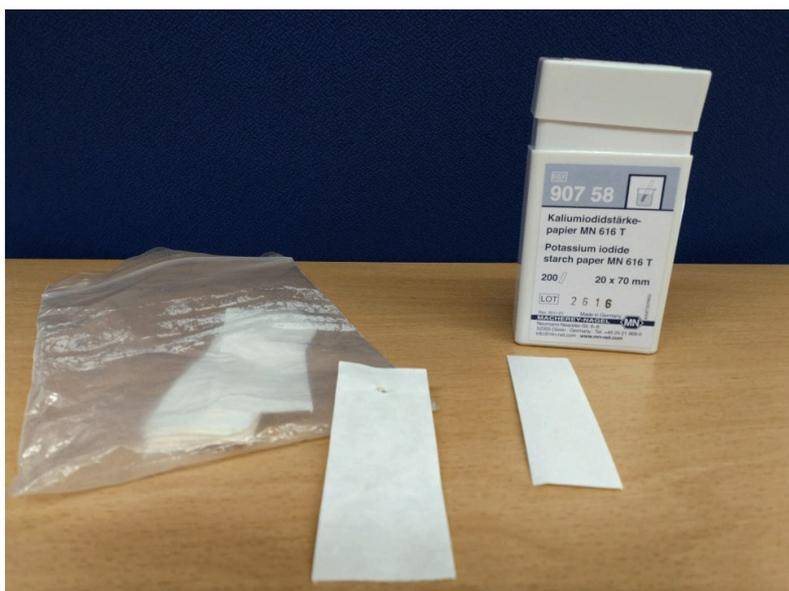
**Figura 7:** Comparação entre a tira de papel de medição preparada de acordo com o procedimento descrito acima (esquerda) e uma tira comercial(direita).
