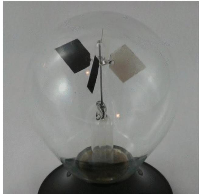
Figura 1. Ejemplo del radiómetro de Crookes.
