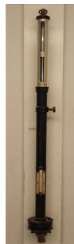
Figura 1. Barómetro de mercurio usado en una estación meteorológica. Fuente: <http://www.ufjf.br/labcaa/equipamentos/>.
