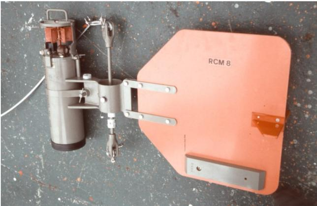
Figura 2. Correntómetro mecánico modelo RCM8 fabricado por Aanderaa Instruments. Fuente: Imagen cortesía de Dr. Ramiro Varela, Universidad de Vigo.
