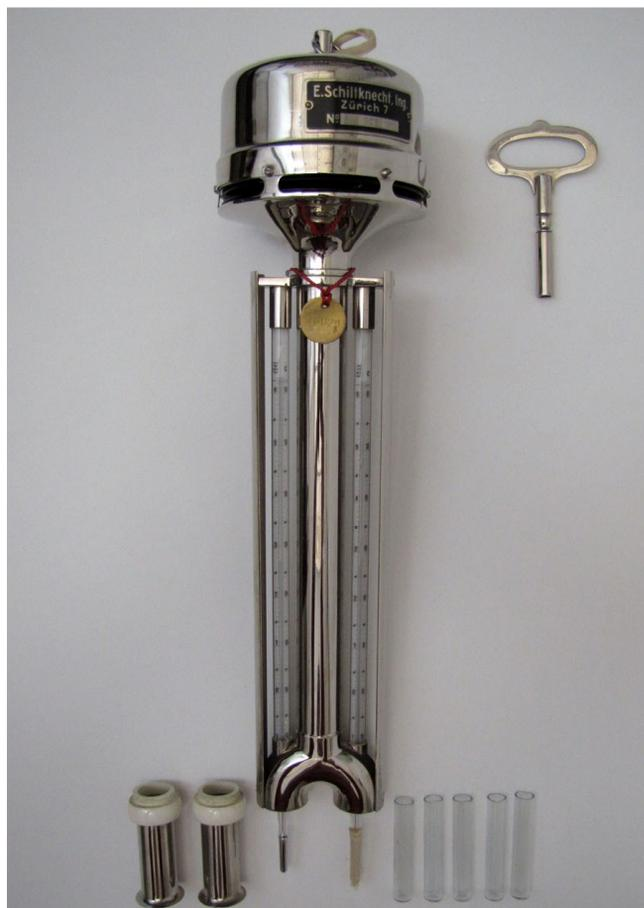
Figura 2. Psicrómetro portátil tipo Assman. Fuente: Martín & Pina, 2014.
