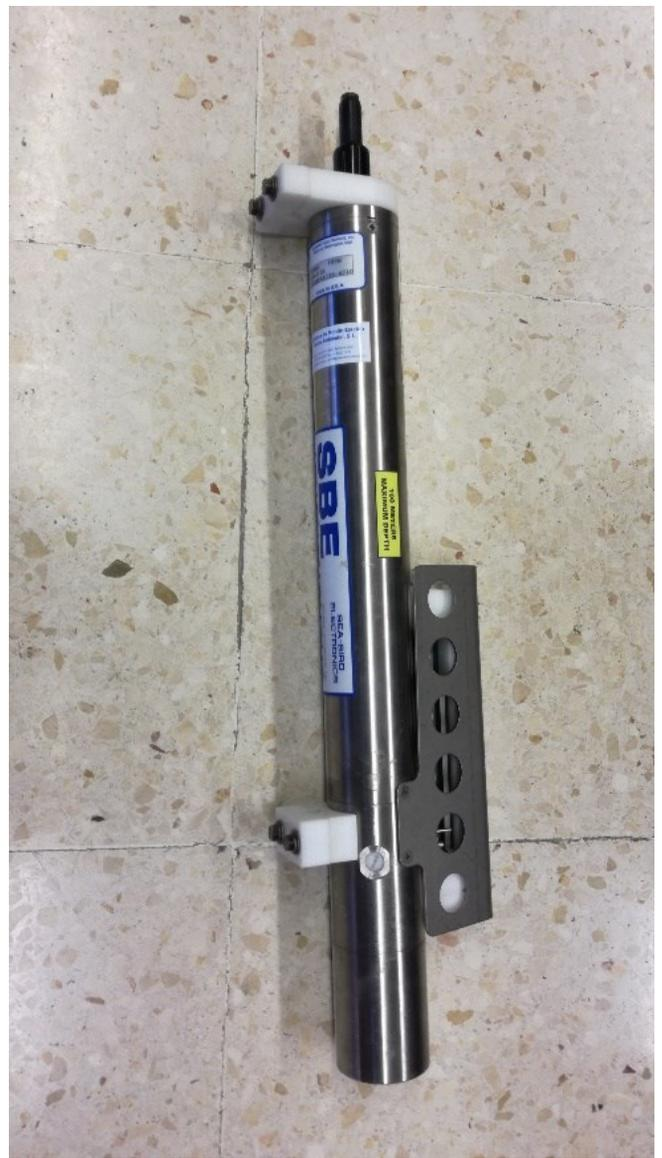
Figura 2. Perfilador CTD SB37SMP fabricado por Seabirds Instruments. Fuente: Imagen propia.
