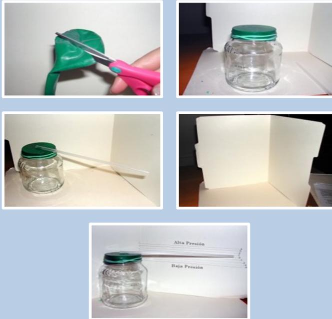
Figura 3. Montaje de Barómetro. Fuente: <http://www.oni.escuelas.edu.ar/2008/cordoba/1324/trabajo/barometro.html>.
