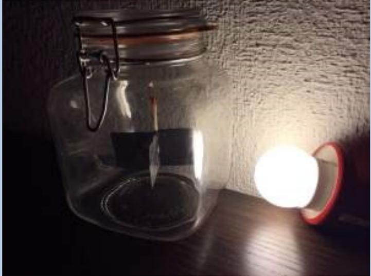
*Figura 3. Ejemplo de un radiómetro de Crookes casero. Fuente: <https://lacienciaencasa3.wordpress.com/2014/12/07/radiometro/>.*
