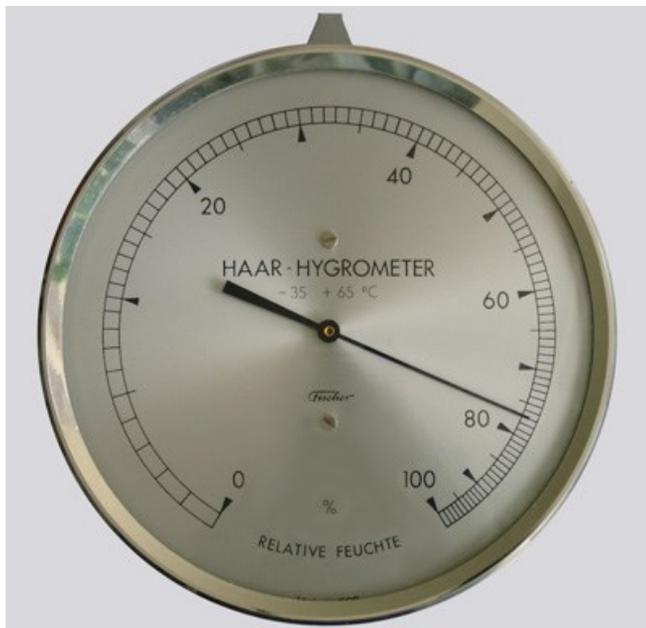
Figura 1. Higrómetro basado en el uso de fibras sintéticas. Fuente: Wikimedia Commons.
