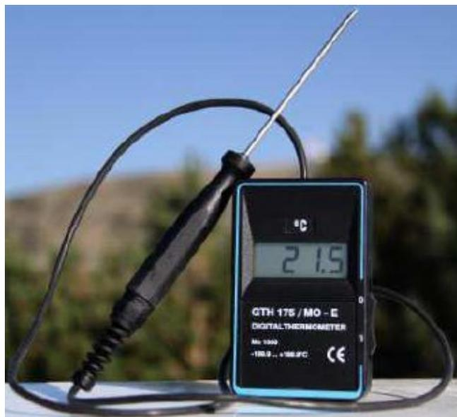
Figura 4. Termómetro de nieve. Fig. 49 de la Guía para la Observación Nivometeorológica (edición 2015) de la AEMet.
