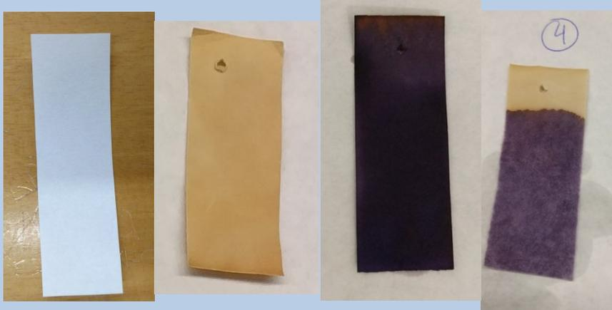
*Figura 3. Coloración de las tiras según los pasos de medición del ozono. De izquierda a derecha: tira sin exponer y seca, tira expuesta 12 horas, dos tiras tras ser mojadas en agua destilada y que han absorbido distintas concentraciones de ozono. Fuente: Imagen propia.*
