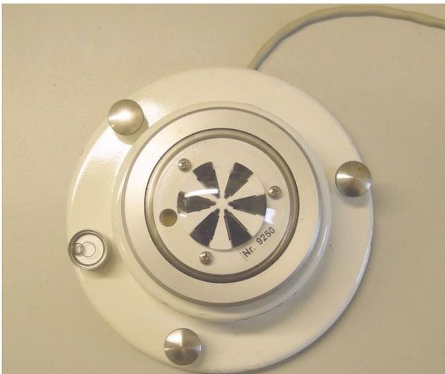
Figura 2. Ejemplo de un piranómetro formado por láminas bimetalicas. Fuente: Imagen propia.
