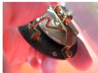
Figura 2. Barómetro aneroide y su interior. Fuente: [http://teleformacion.edu.aytolacoruna.es/AYC/document/atmosfera\\_y\\_clima/presion/medirpres2.htm](http://teleformacion.edu.aytolacoruna.es/AYC/document/atmosfera_y_clima/presion/medirpres2.htm).
